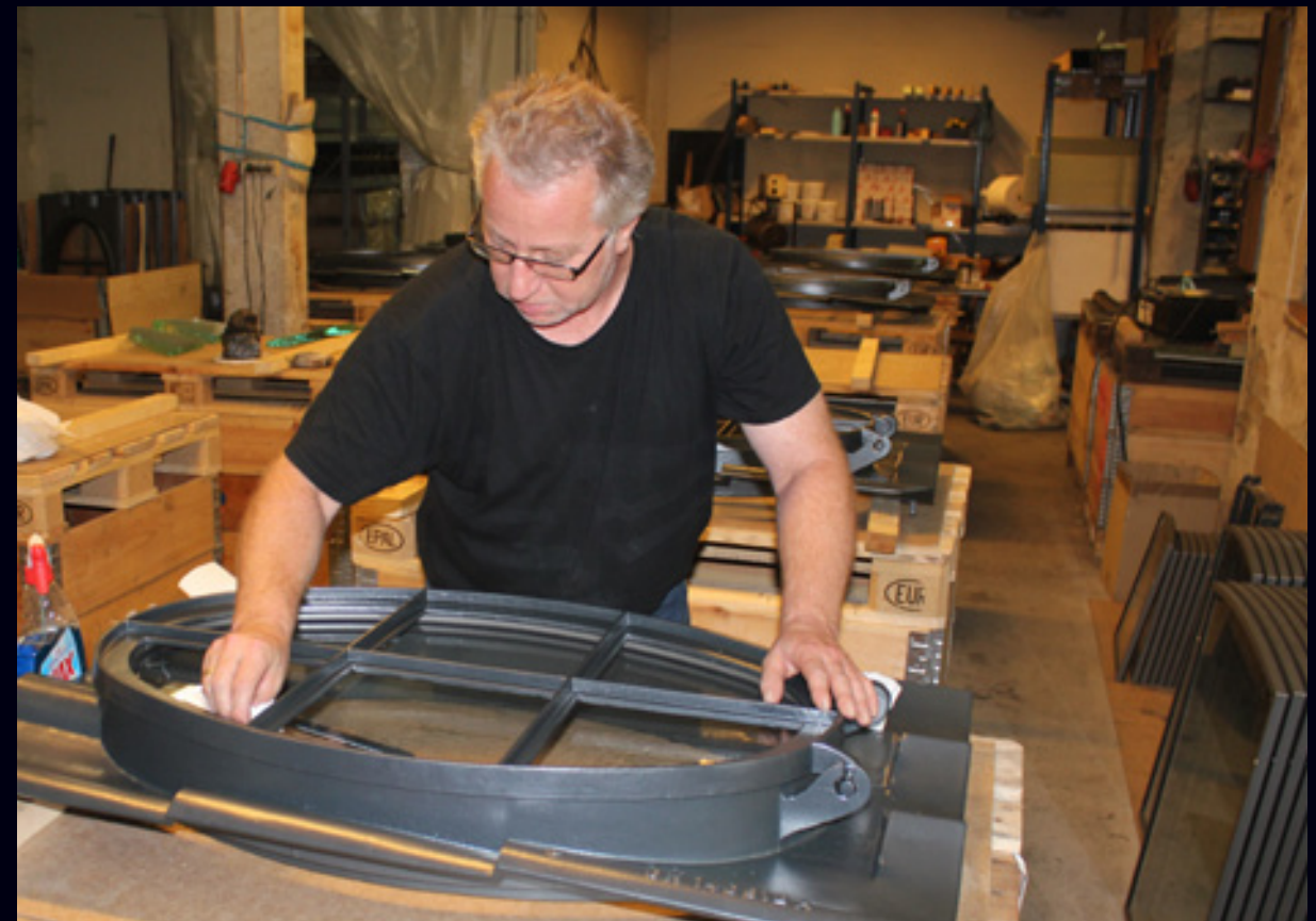
Når vinduerne er støbt og malet håndsamles de. Rammen isættes glas og kitfals. Beslag monteres. Vinduet testes og klargøres og pakkes til afsendelse.
