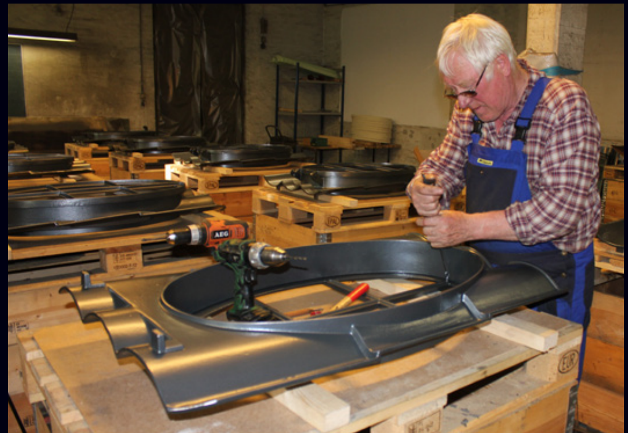
Når vinduerne er støbt og malet håndsamles de. Rammen isættes glas og kitfals. Beslag monteres. Vinduet testes og klargøres og pakkes til afsendelse.
